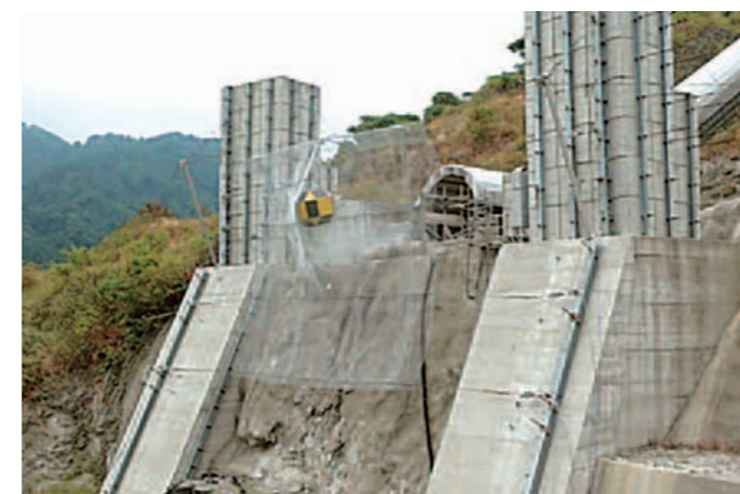
支柱に重錘を衝突させる実験
