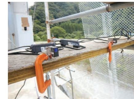
速度計測システム (レーザー)
