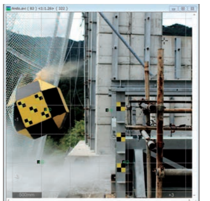
高速カメラによる重錘入射角度の確認
