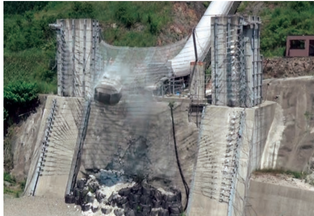
重錘衝突時の変形状況 KB-NF5.0-2型 実験供試体
