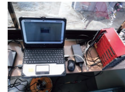
張力測定用計測器設置状況
