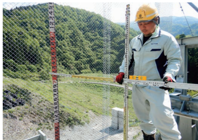
載荷位置測定状況
