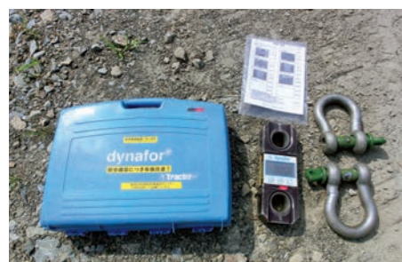
質量測定に用いる荷重計
