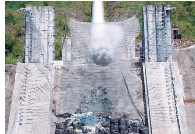
重錘衝突時の阻止面 KB-NF5.0-2型 実験供試体
